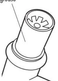
SCH 请在组装前擦除前叉上管、Thomson 车把立管内侧以及前叉上管夹钳内的油污。可以使用外用酒精，它是一种非常有效的去污剂。
